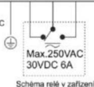
**Schéma zapojení svorkovnice ASES-DATVS-FSS/II/DC:**
