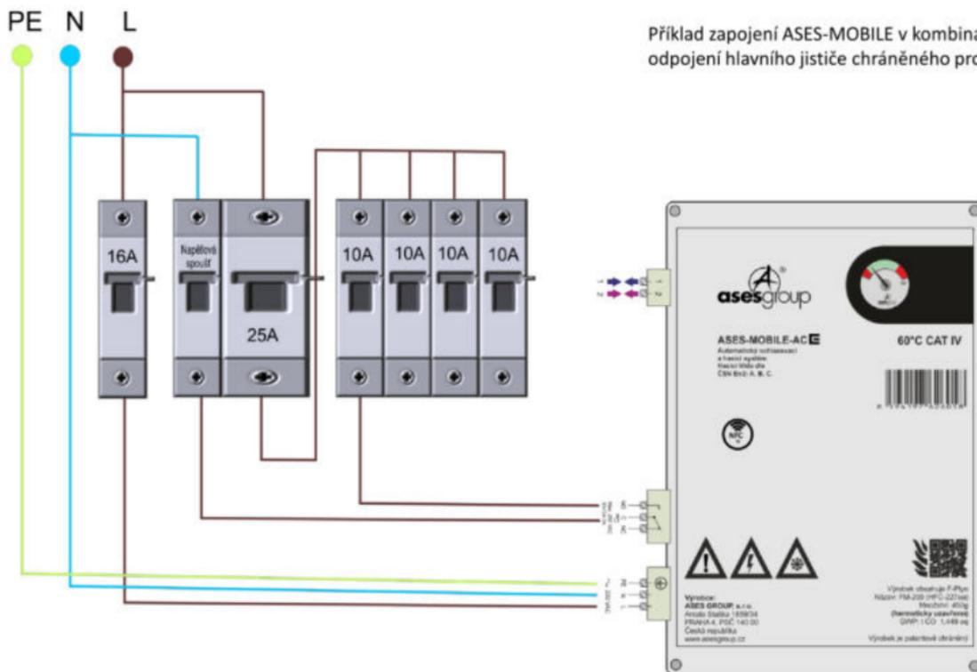
Příklad zapojení ASES-MOBILE v kombinaci s napěťovou spouští pro odpojení hlavního jističe chráněného prostoru
